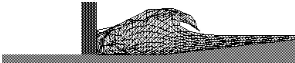
Fig. 11 - Influence de la profondeur pour un piston se déplaçant à 1 m/s, au même instant, t=0,58 s. Le sommet de la vague se déplace à peu près à la même vitesse (double de celle du piston) dans les trois cas. La base de la vague se propage d'autant plus vite que la profondeur est grande.
