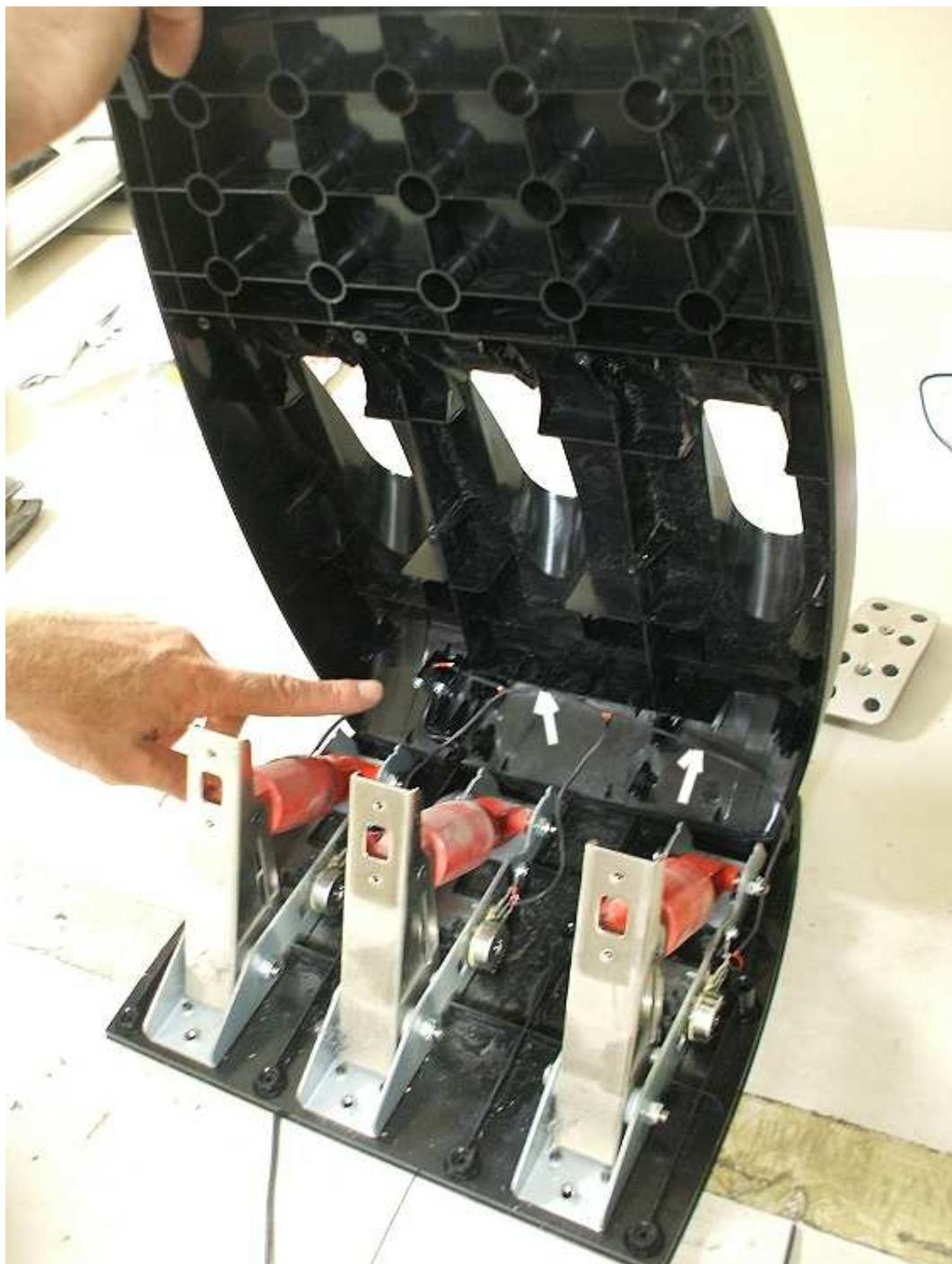
et retournez le carter pour le stabiliser, sans que le fil électrique ne soit trop en tension. Ca donne la position de la photo suivante.
