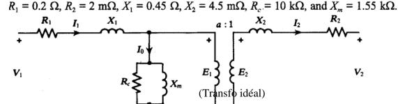
Donner le schéma équivalent ramené au secondaire en précisant les valeurs numériques des paramètres.
